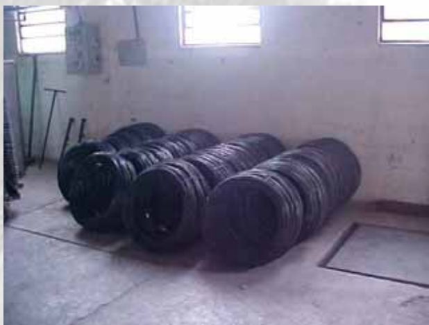
1. Alma: aço baixo teor de Carbono cortado na forma de varetas.
