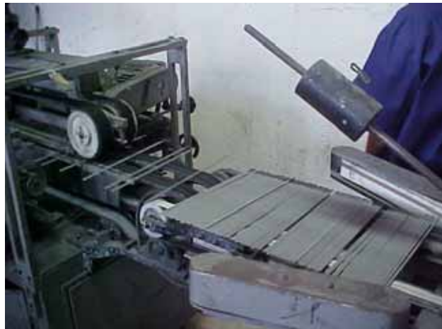
6. Acabamento do eletrodo revestido, fazer as pontas e identificação.
