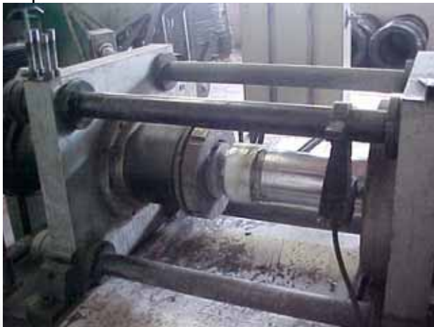
5. Prensa: a alma (vareta) e o bloco do revestimento são prensados juntos.
