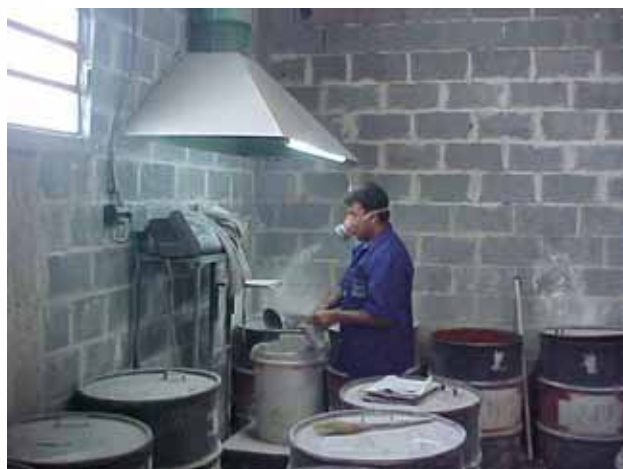
2. Pesagem e peneiramento das matérias-primas do revestimento.
