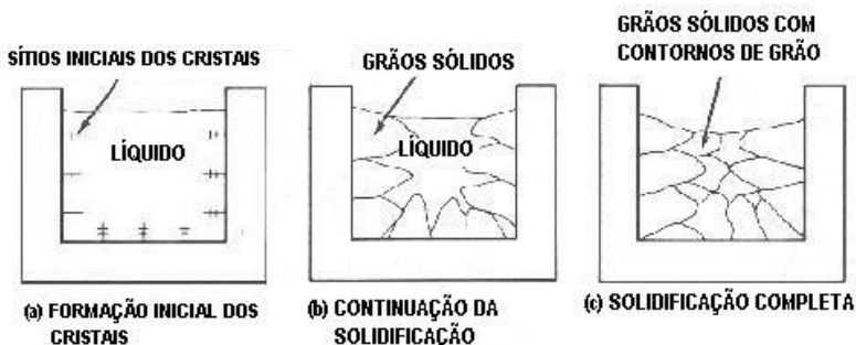
Figura 6 - Processo de solidificação dos metais
