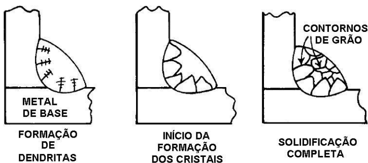
Figura 8 - Processo de solidificação de uma junta soldada
